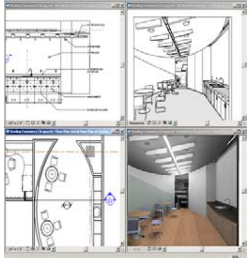
Şekil 3 BIM ile tasarlanmış bir mekan [3]
